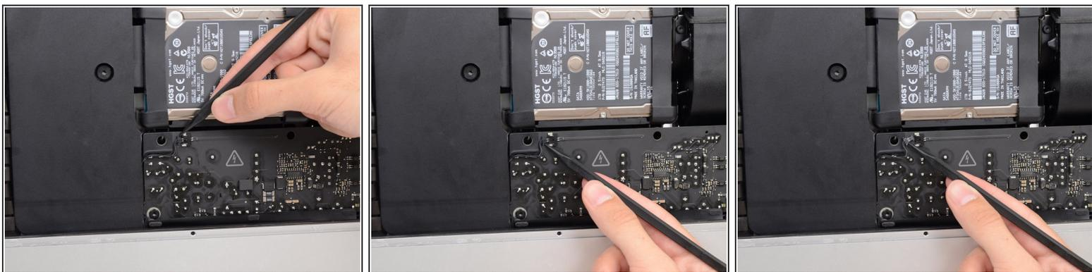
**⚠ 次の手順では、電源ユニットの露出面に手を近づけます。電源ユニットの表面または露出したはんだ部分に触れないでください。触れてしまうと、ボードに取り付けられた多くの大型コンデンサからの高圧ショックを受けてしまう危険性があります。**
