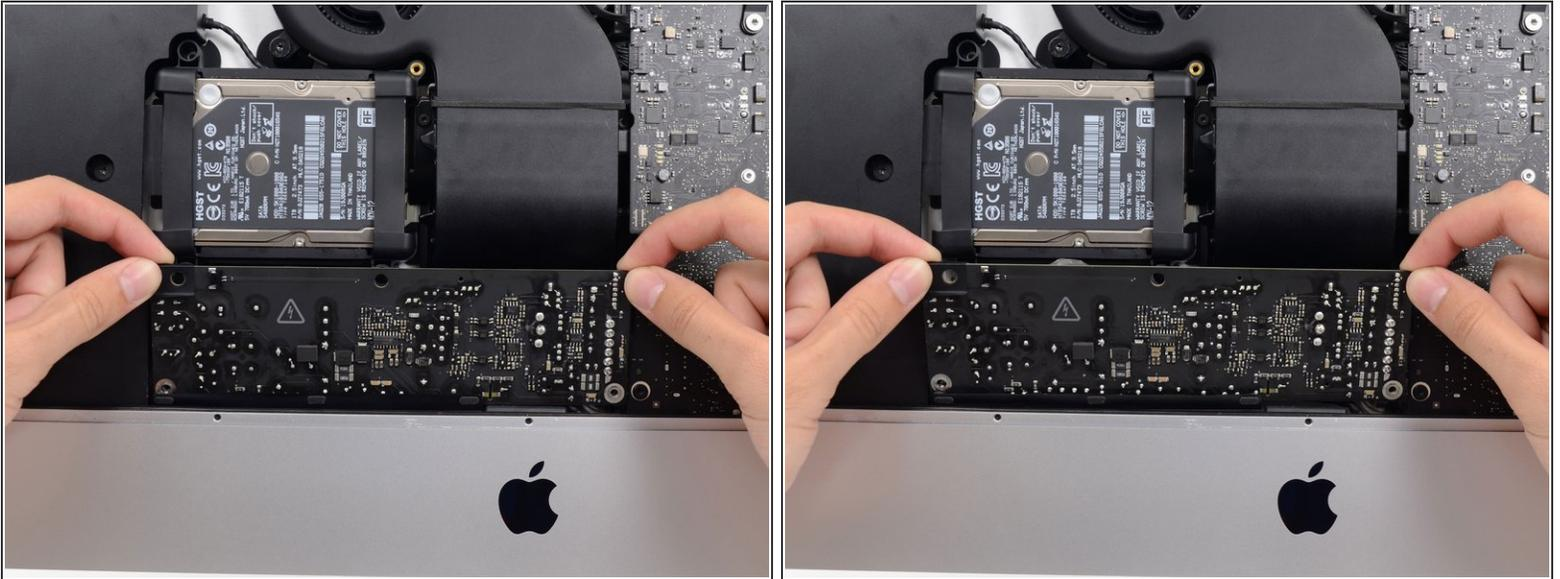
**⚠ 電源ユニットで作業するときは、電源ユニットの背面にあるコンデンサのリード線や露出したはんだ接合部に触れないよう、くれぐれもご注意ください。ボードの端のみを扱ってください。**
