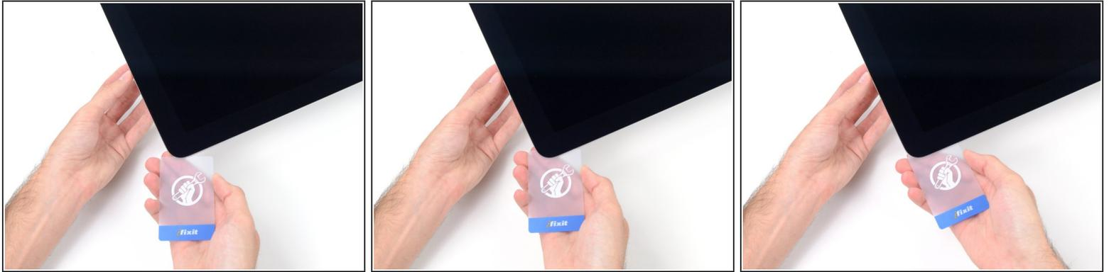
**i** 開口ツールがディスプレイ上の接着剤の大部分を切断できても、ディスプレイはわずかにケースに装着されたままです。残りの接着剤から完全に乖離するため、プラスチックカードを使用してください。
