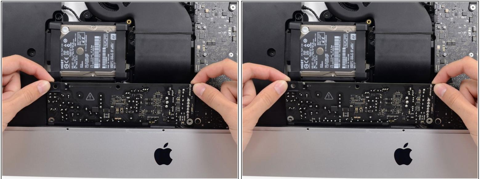
⚠️ パワーサプライの作業をする際は、パワーサプライの裏側に付いている露出した半田付け部分やコンデンサに接触しないよう、特にご注意ください。ロジックボードの端のみを持って作業を続けてください。
