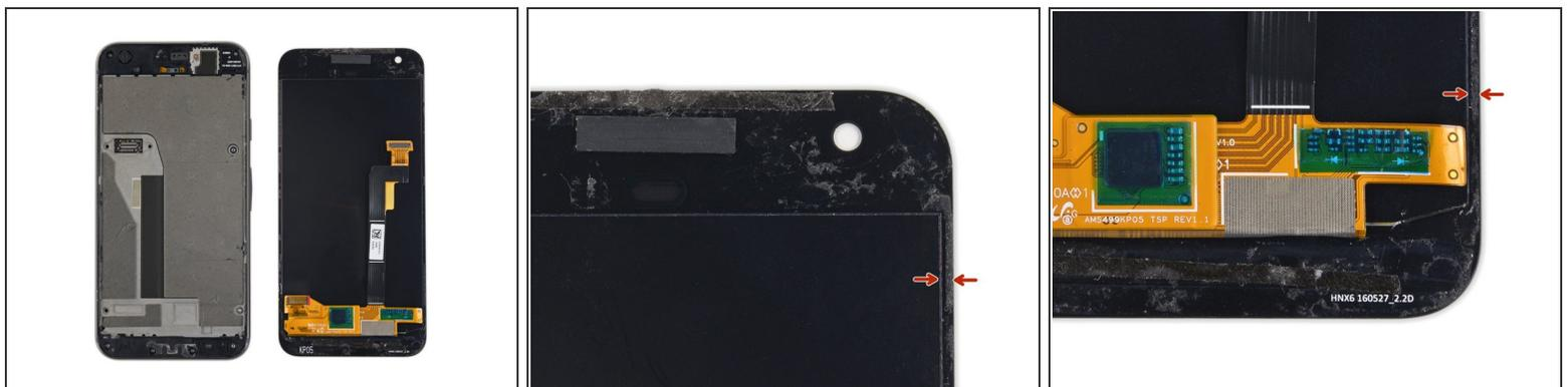
① **i** 次の手順では、ディスプレイをPixelの筐体に固定している接着剤を切り込みます。
