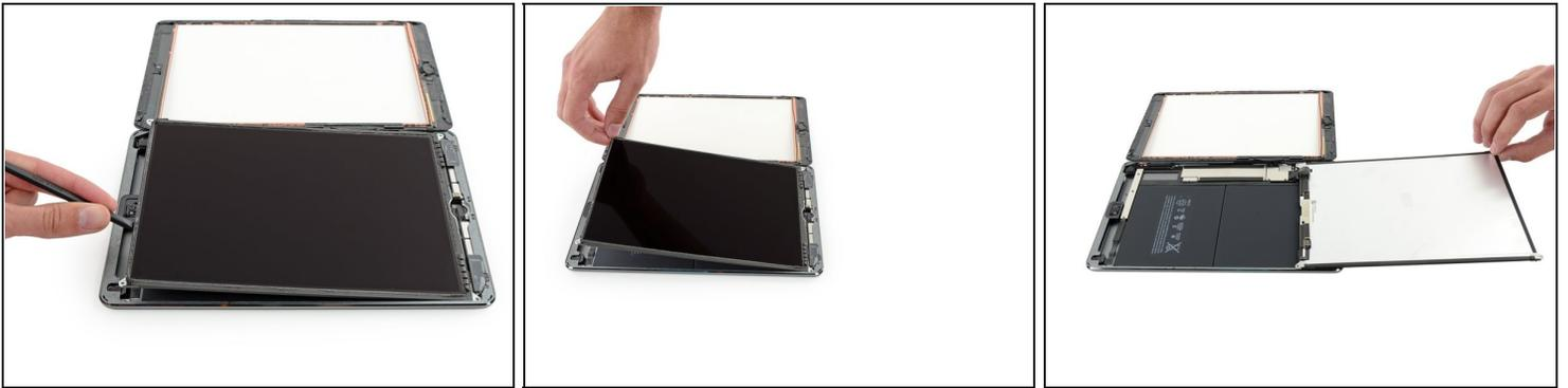
⚠️ 液晶ディスプレイをを完全に取り外さないでください。幾つかのケーブルがホームボタン上でiPadに繋がっています。正面カメラの端から持ち上げてください。
