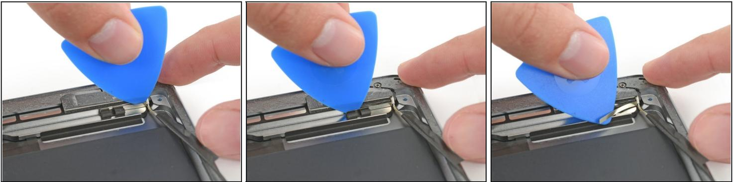
① 内蔵スピーカーに留められたアンテナケーブルに接続しているブラケットがあります。接着剤はアンテナを取り出すためには切断しなければなりません。
