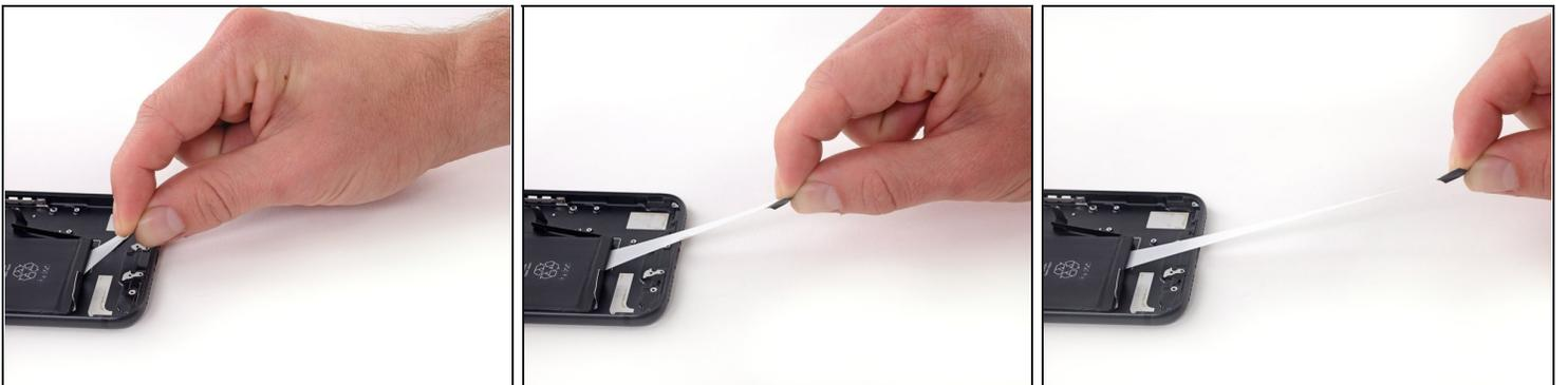
**⚠** この手順では接着ストリップを水平に保ったまま、シワが寄らない状態で作業を進めてください。シワが入ったストリップは、引き抜く作業中、裂けてしまいます。
