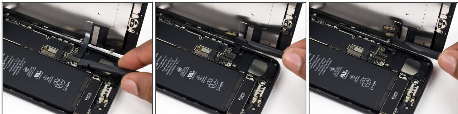
**⚠ この手順でケーブルの接続を外したり再接続する前にバッテリーが切れていることを確認してください。**
