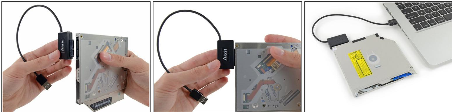
ⓘ ハードドライブをまだ捨てないでください！ [SATA光学ドライブUSBケーブル](#)があれば、外付けで光学ドライブをまだ使用することができます。
