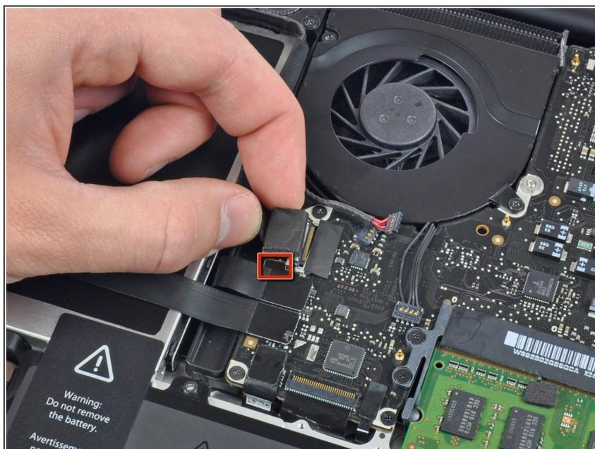
**⚠** カメラケーブルの接続を外す前に、基板に接着剤で留められた小さな透明のプラスチックのケーブルリテーナー(赤く囲まれた箇所)をスライドしてください。基板から外す際にカメラケーブルコネクタからリテーナーをスライドするため、他のコンポーネントにダメージを与えないようご注意ください。
