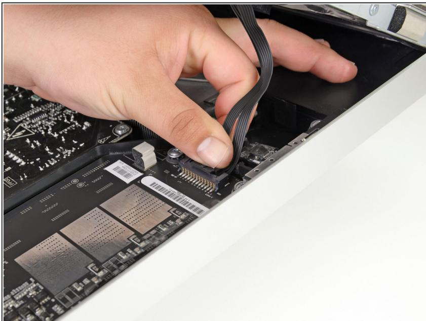
**⚠** この作業では、素手を電源ユニットの背面に差し入れます。電源ユニットの背面のボードがむき出しになっていますが、大容量コンデンサに帯電している高電圧の電流が流れますので、絶対に触れないでください。
