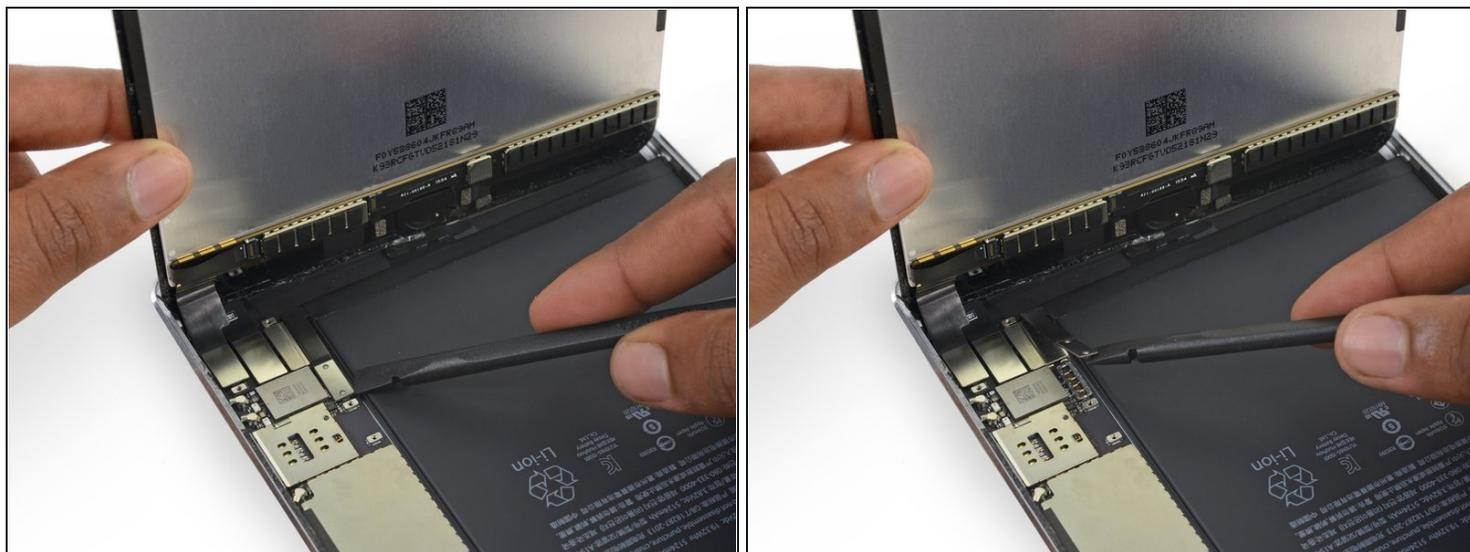
⚠️ ロジックボードからプレスコネクタの接続を外す際、基板上のソケットを切り裂かないようにコネクタをまっすぐ持ち上げているか確認してください。
