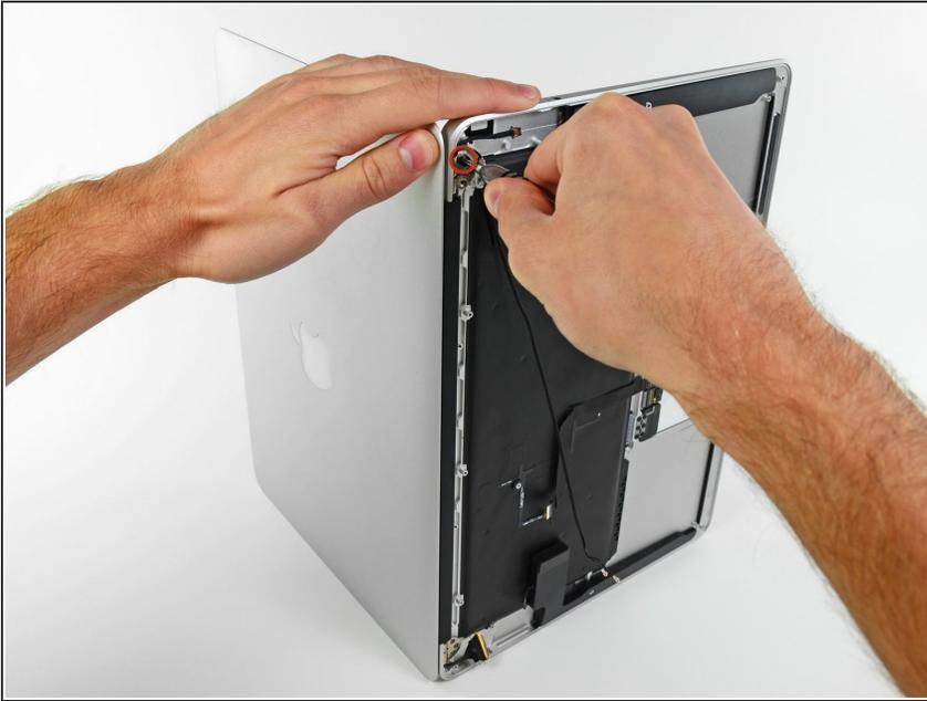
**⚠** 最後のディスプレイのネジを外す前に、もう一方の手でディスプレイと上部ケースをしっかりと持ってください。コンポーネントをテーブル上に落下させてしまうと、高額修理となる損傷を引き起こす可能性があります。
