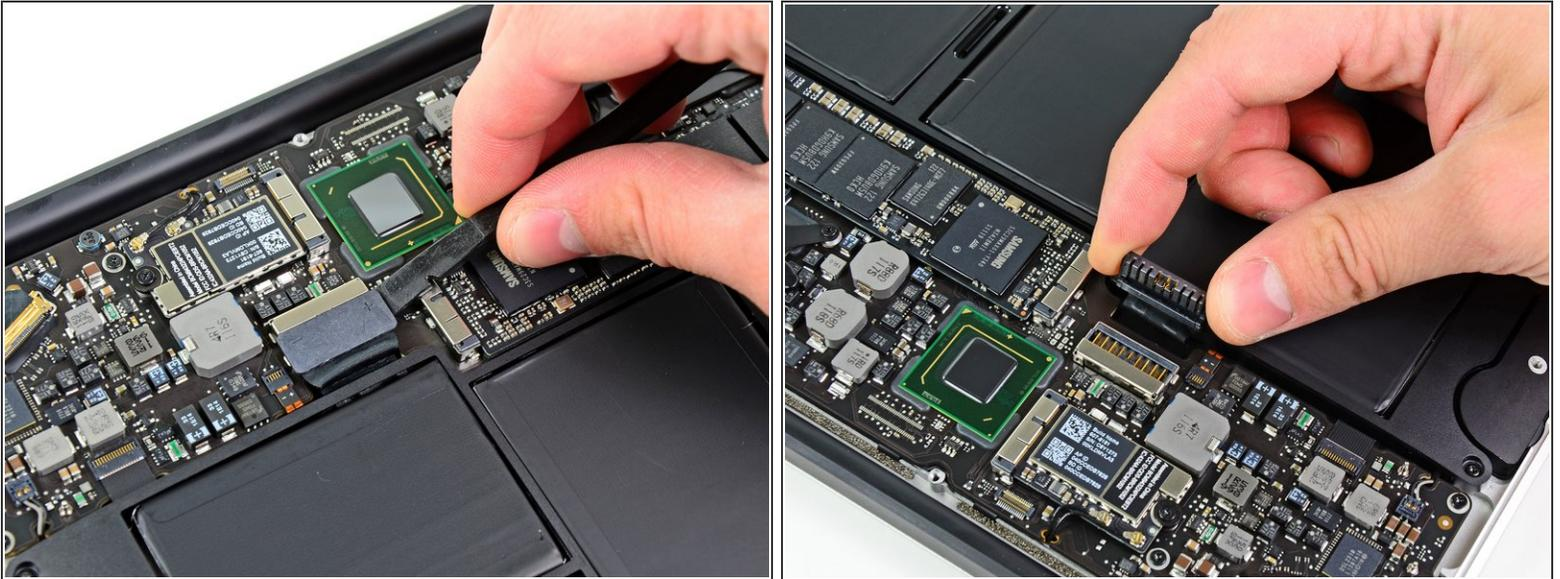
**⚠** この手順では、作業中にパーツがショートしないように、バッテリーを取り外します。
