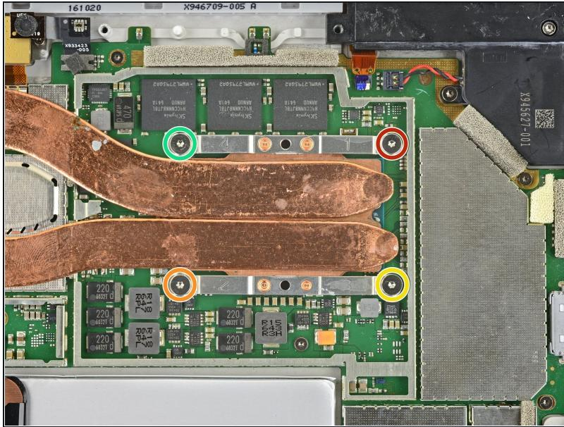
● T5トルクスドライバーを使って、CPU周辺のヒートシンク上に留められたネジを以下の順番で1回転ずつ、外れるまで回します。
