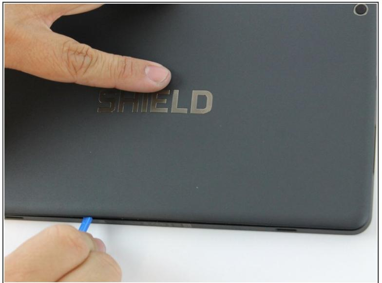
バックパネルは複数のツメでデバイスに固定されています。これらに力を加えてバックパネルを持ち上げて外します。
