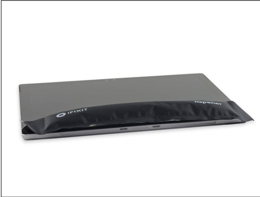
① ディスプレイはデバイスのフレームに固く接着されています。
