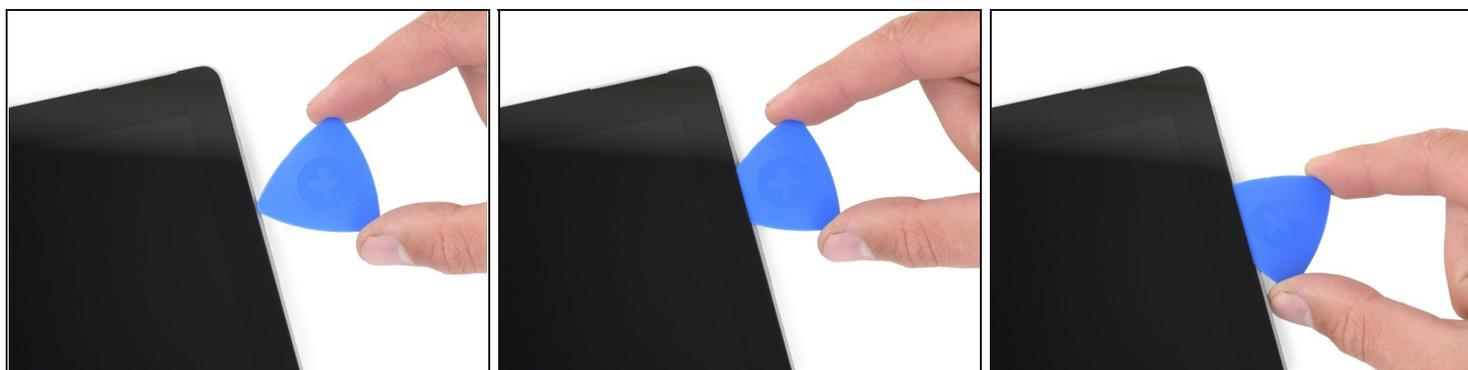
⚠ デリケートなアンテナケーブルは、スクリーン上端の下に搭載されています。破損しないように注意して作業を行ってください。
