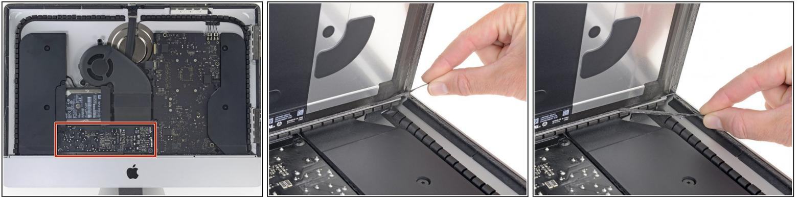
**⚠ 必要に応じてプラスチックカードを使って、接着ストリップの残留部分を切断してください。**
