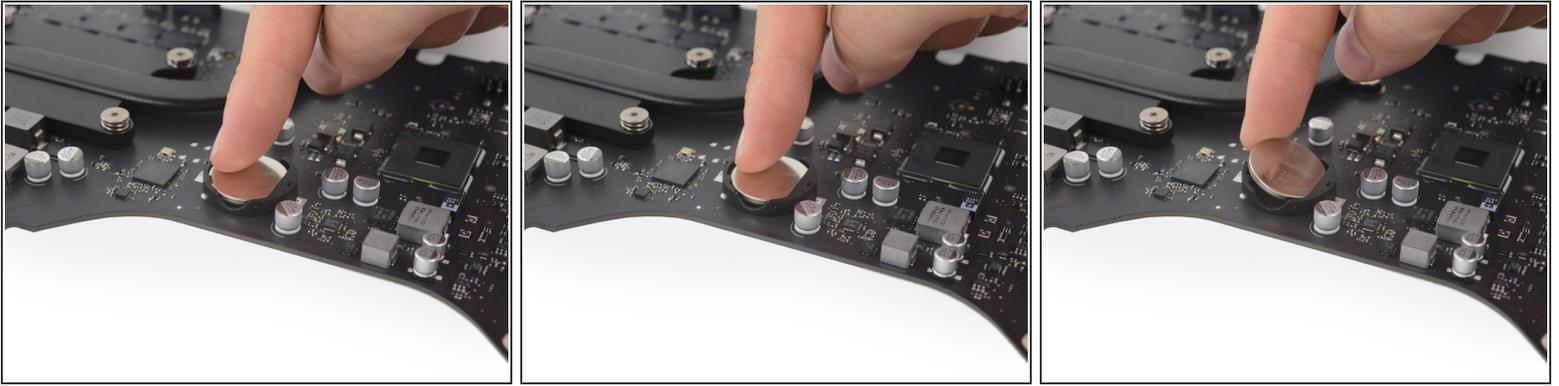
**i** PRAMバッテリーはバネコンタクトと小さなプラスチックの突起で固定されています。
