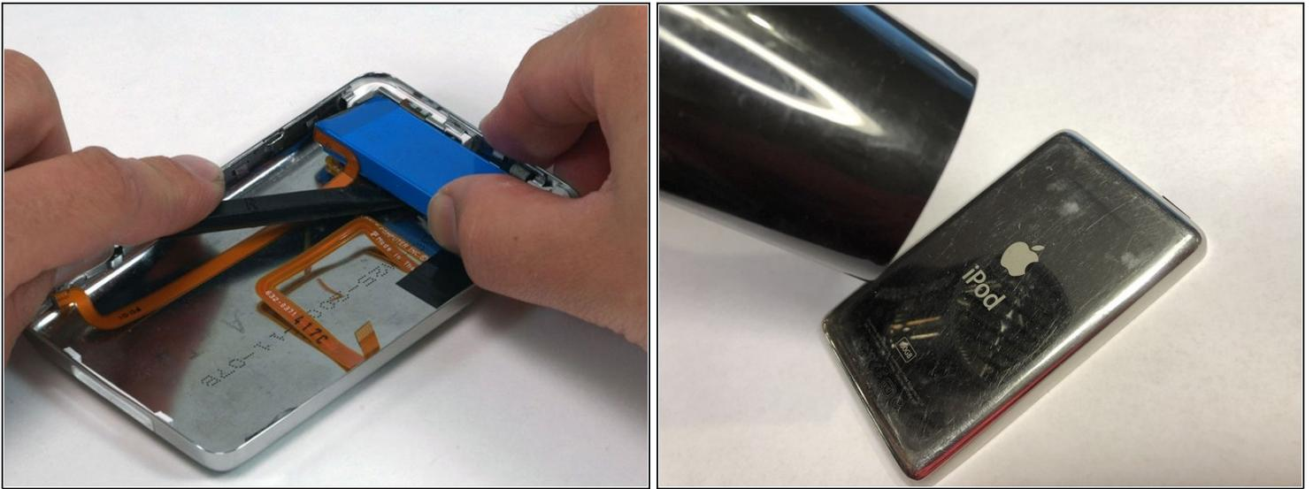
⚠ バッテリーは、リアパネルに接着剤で留められています。バッテリーを取り外す際、オレンジ色のヘッドホンジャックまたはホームボタンリボンケーブルを切断しないようご注意ください。
