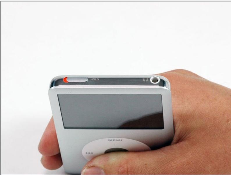
⚠ 安全のため、デバイスを分解する前にiPodを完全に放電してください。こうすることで、修理中に誤ってバッテリーが損傷した場合、危険な熱現象が発生する危険性が低くなります。バッテリーが膨張している場合は、[適切に処分してください](#)。
