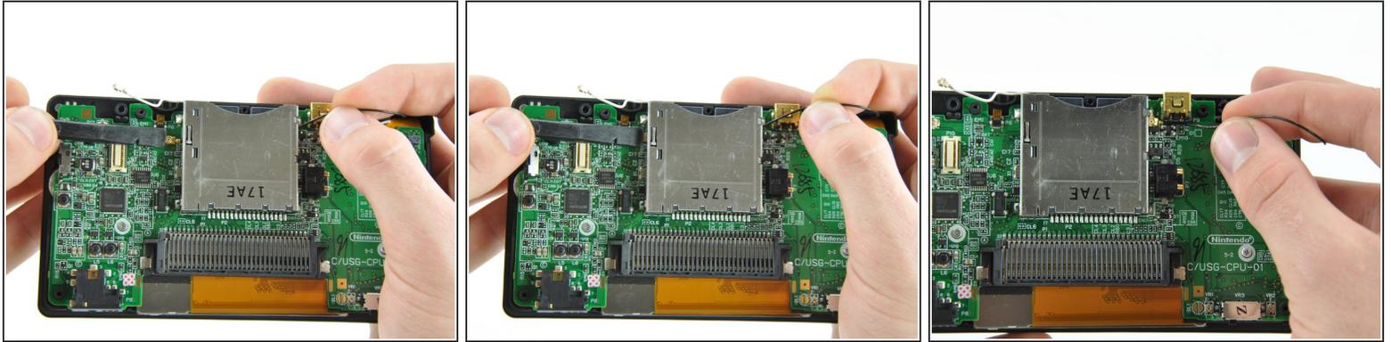
**⚠** 次の手順では、DS Liteのゲームカートリッジリーダーとマザーボードの間のアンテナケーブルを引っ張る必要があります。ケーブルやマザーボードにダメージを与えないようにするため、抵抗を感じたら引っ張るのを止めてください。
