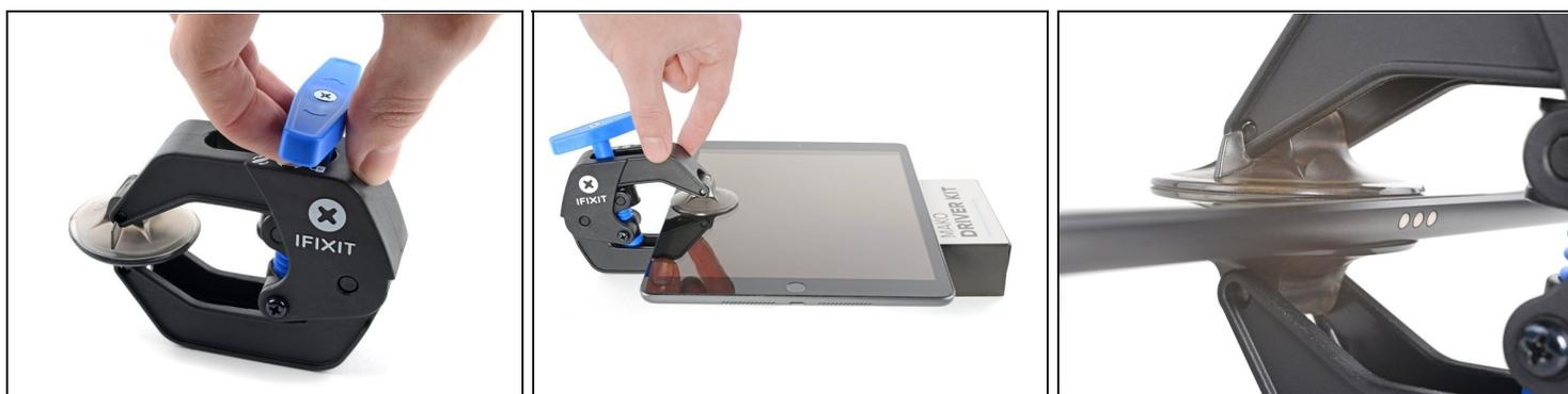
① 次の2つの手順では、デバイスの開講作業を簡単にするために開発されたツール、リバースクランプの使い方を紹介します。リバースクランプを使用しない場合は、この2つの手順をスキップして別の方法をご覧ください。
