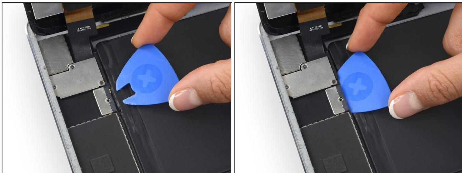
① ショートする危険性を減らすために、バッテリー用絶縁ピックを使用してバッテリーの接続を切って下さい。
