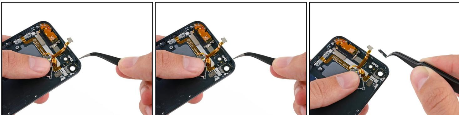
① 電源/スリープボタンは、リアケースからひとりでに落下する可能性があるため、この時点で取り外します。
