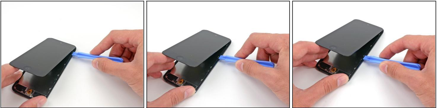
① 次の手順では、画面を囲むプラスチックフレームを緩めて解放します。いくつかのクリップでリアケースに接続されています。
