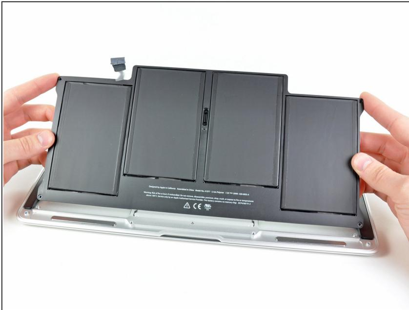
**⚠** バッテリーを取り扱う際は、露出したリチウムポリマーセルに接触したり押さえたりしないでください。
