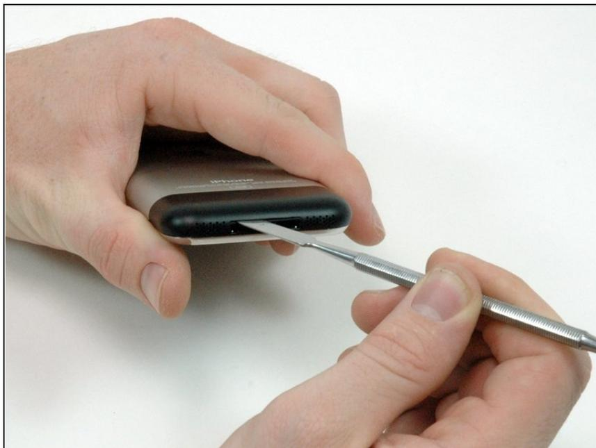
⚠️ メタル製スパジジャーをドックコネクタとアンテナカバーの間にスライドさせてください。ドックコネクタ自体には差し込まないでください。
