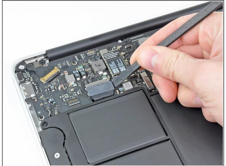
**⚠ このステップでは、作業中に接触して他の部品にショートさせるのを避けるためバッテリーを外します。**
