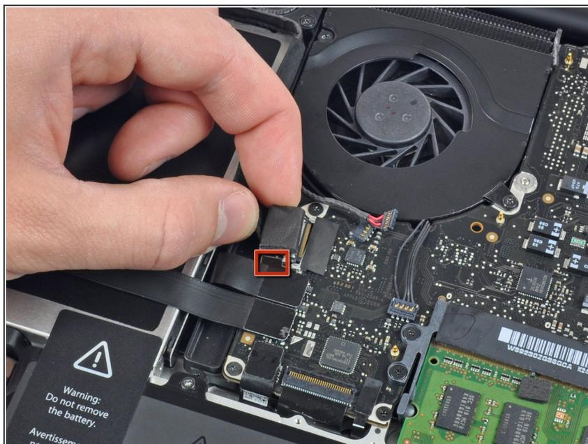
⚠ カメラケーブルの接続を外す前に、作業の邪魔にならない位置へ接着剤で基板に固定された(赤色でマーク)小さな透明のプラスチック製ケーブルリテーナーをスライドする必要があります。カメラケーブルのコンネクタからリテーナーをスライドする際に、基板上のコンポーネントにダメージを与えないようご注意ください。
