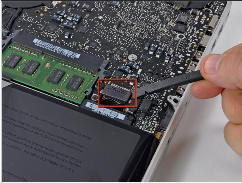
**⚠** 作業前の注意点として、放電を防ぐためロジックボードからバッテリーコネクタの接続を外してください。
