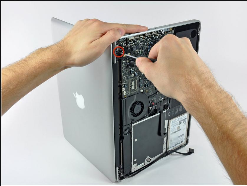
**⚠** 左手で必ずディスプレイと上部ケース両方を押さえてください。ディスプレイと上部ケースが外れてしまうと落下の原因となり、各コンポーネントに致命的なダメージを与えてしまいます。
