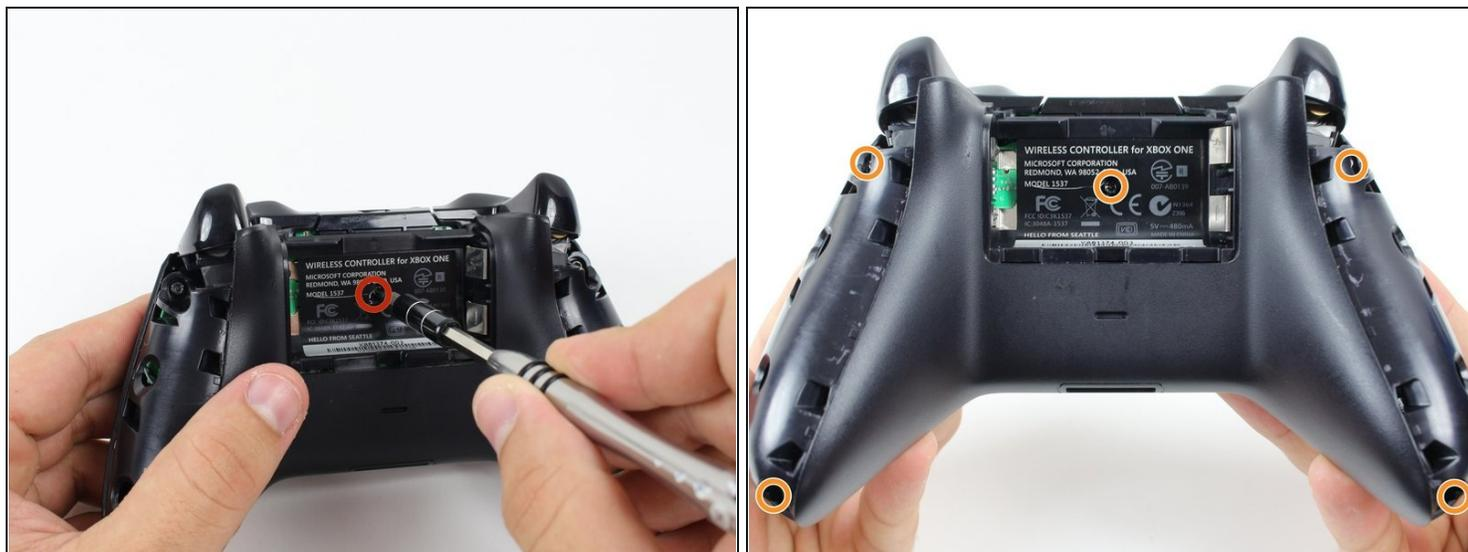
① ラベルの裏のコントローラ中央部分にネジが一本隠れています。
