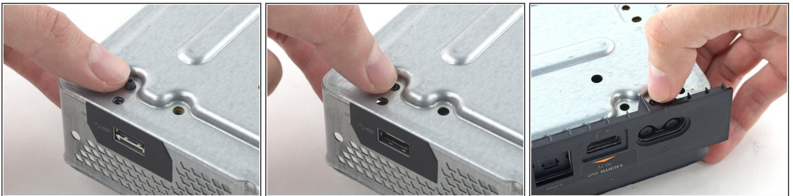
① 2つの小さなプラスチック製のプラグは背面メタルケースから突き出ています。—1つはUSBポート側の下から、そしてもう1つはポートのACの下からです。これらのプラグは底のメタルケースに固定されており、マザーボードを取り外し難しくしています。
