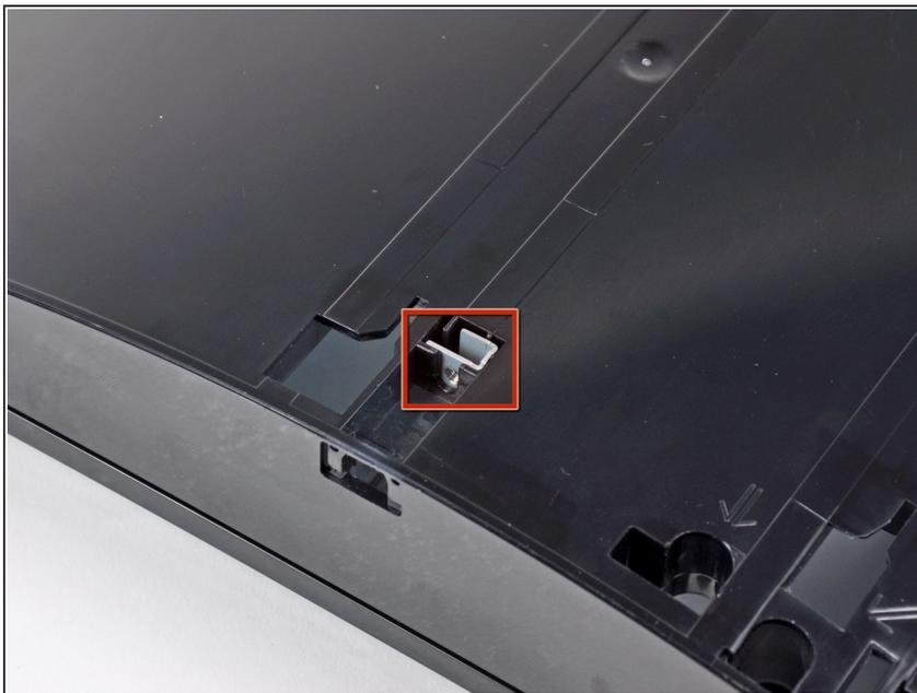
**⚠** トップカバーには固定されていない金属製の小さなブラケット（ねじ受け）があります。よって紛失しないよう注意して下さい。
