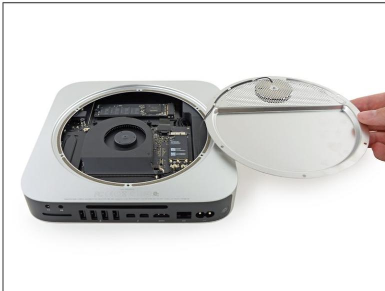
**!** アンテナプレートを完全に本体から取り外さないでください。アンテナプレートはまだ、Mac miniとアンテナケーブルで繋がっています。
