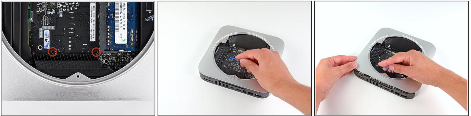
**⚠️** ロジックボードを取り外すには、赤で表示されている穴に2本の円筒形ロッドを挿入してください。赤で表示されている穴以外のロジックボードの穴に挿入してしまうと、ロジックボードが破損する可能性があります。
