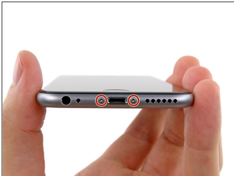
**⚠️ 解体作業を始める前に、iPhone6のバッテリー残量を25%以下まで消費してください。充電された状態のリチウムイオンバッテリーに穴を開けてしまうと、引火や爆発を引き起こすことがあります。**
