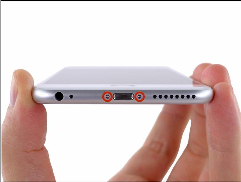
⚠ 作業を始める前に、バッテリーの残量を25%以下まで消費してください。充電されたリチウムイオンバッテリーにアクシデントで穴を開けてしまうと、引火や爆発の原因となります。
