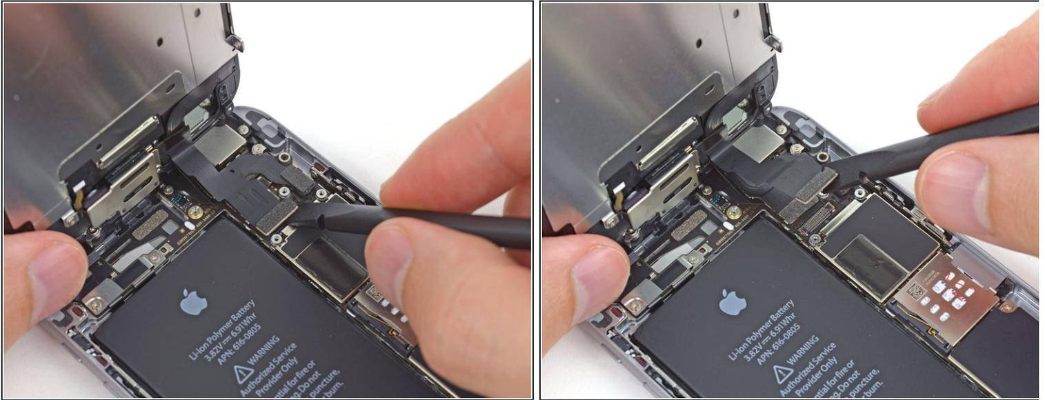
**⚠ 次の4つの手順ではケーブルコネクタのみに差し込んで持ち上げ、基板上のソケットには接触しないでください。**
