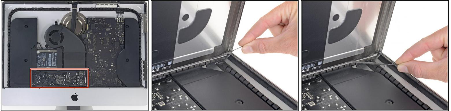
**⚠** 必要に応じて、プラスチックカードを使って底側の接着ストリップの一部を切断することもできます。
