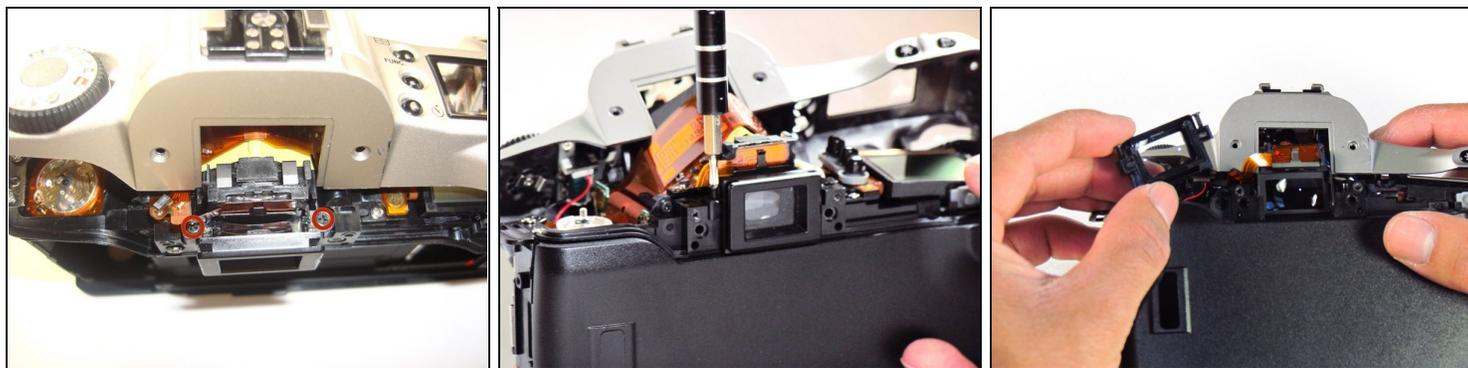
● ドライバーを使用して、2本の黒い 8.8 mm プラス #1 ネジを取り外します。
