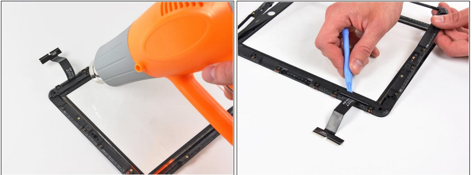
**⚠** この手順では、デジタルケーブル付近のプラスチックフレームを加熱して取り外します。このリボンケーブルは非常に細く、熱に弱いため、直接加熱しないでください。
