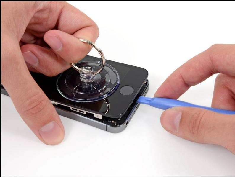
⚠️ フロントパネルにはクリップが付いており、デバイス本体部分と幾つかのリボンケーブルで繋がっています。ここでの作業の目的はクリップを外し、ケーブルの接続が外れる程度まで本体を開口することです。破損を防ぐために、ゆっくりと丁寧に作業を進めてください。
