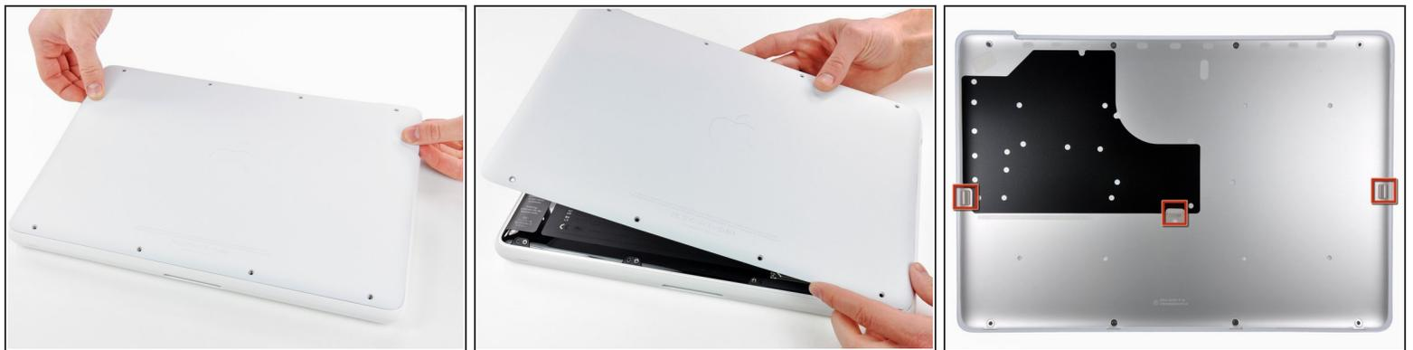
**⚠** 下部ケースは、ゴムで覆われたアルミニウムで構成されています。再組み立て時に組み立てられなくなってしまうので、外す際に下部ケースを曲げすぎないでください
