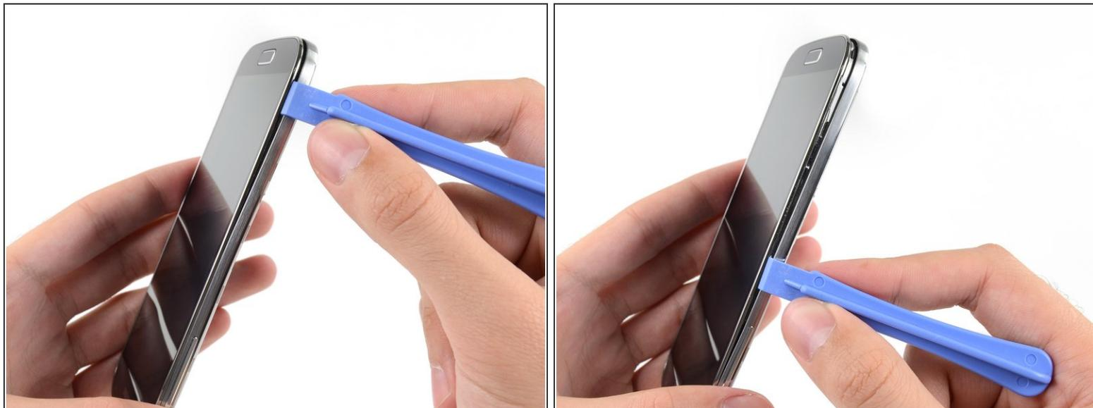
① ミッドフレームはミッドフレームのクロムベゼルの裏側に、ディスプレイアセンブリに幾つかのプラスチッククリップで止められています。
