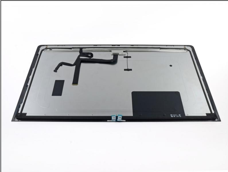
① ディスプレイパネルを交換する場合は、古いパネルから新しいパネルに追加でコンポーネントを移す必要があります。古いディスプレイと交換用ディスプレイの背面を見比べてください。新しいディスプレイには搭載されていない全てのケーブル、センサーとケーブル、フォーム製緩衝材の有無に注意してください。
