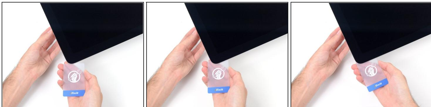
① 開口ツールで作業の大部分は対応できますが、ディスプレイは(完全に剥がれておらず)ケースに若干装着しています。この残りの接着剤を剥がすには、プラスチックカードが必要です。
