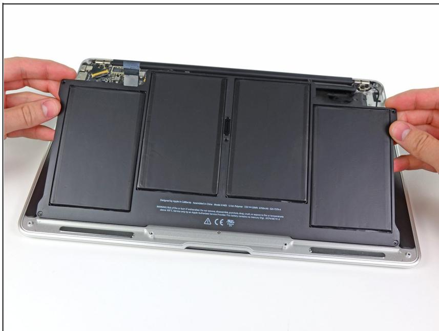
⚠ バッテリーを取り扱う際は、4つの露出しているリチウムイオンバッテリーセルを触ったり、握ったりしないでください。
