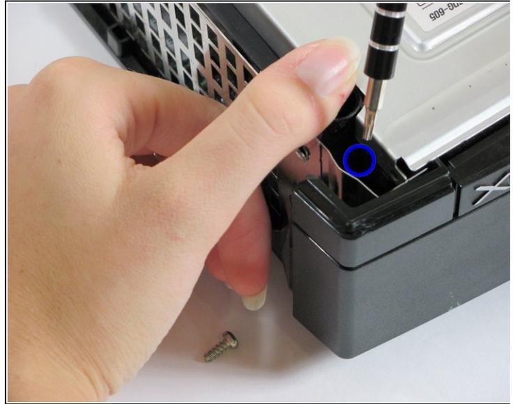
● ハードディスクをXboxに固定している3本の3mmT10ネジを外します。
