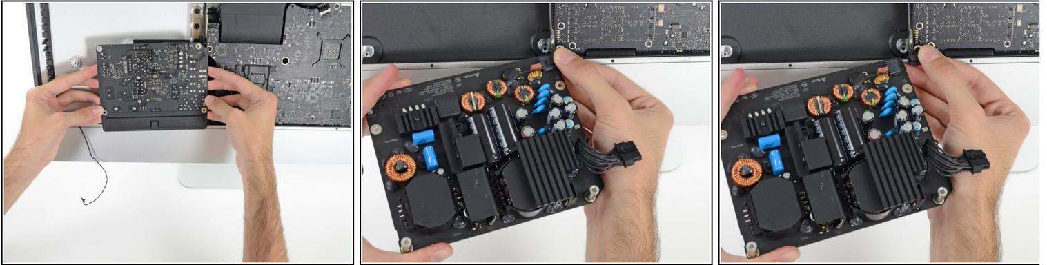
**⚠️ コンデンサのリード線や電源装置の背面の露出したはんだ接合部には触れないよう十分注意してください。ボードの端だけを取り扱ってください。**
