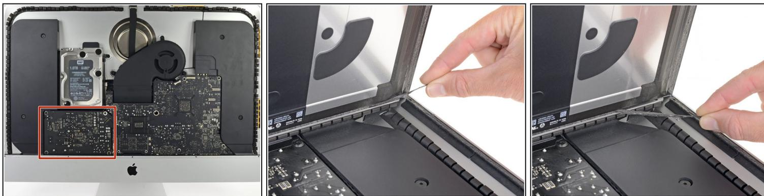
**⚠** コンデンサのリード線または電源の背面の露出したはんだ接合部に触れないように十分注意してください ( 赤色の枠内 ) 。
