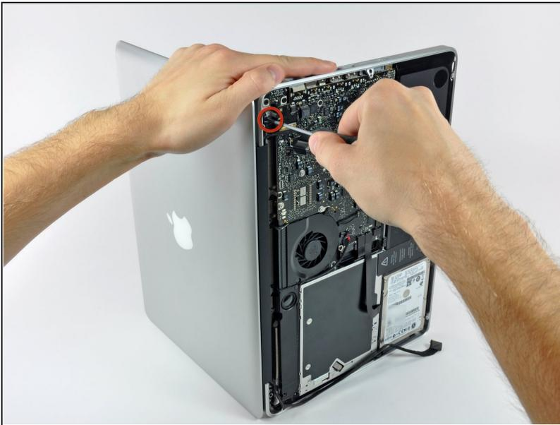
⚠ ディスプレイと上部ケースを同時に左手で押さえてください。手で固定せずに作業をするとディスプレイ/上部ケースが落ちて外れてしまい、各コンポーネントにダメージを与えてしまうことがあります。
