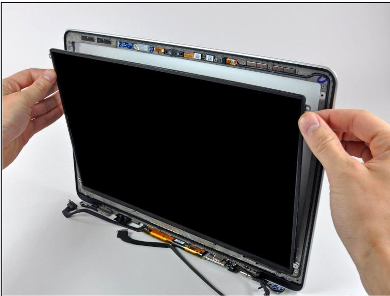
⚠ LCDを完全に取り出さないでください。ディスプレイ下側端に沿った回路は、アルミ製ディスプレイアセンブリ内のディスプレイ凹みの下側端に沿った隙間にくさび形にされている。
