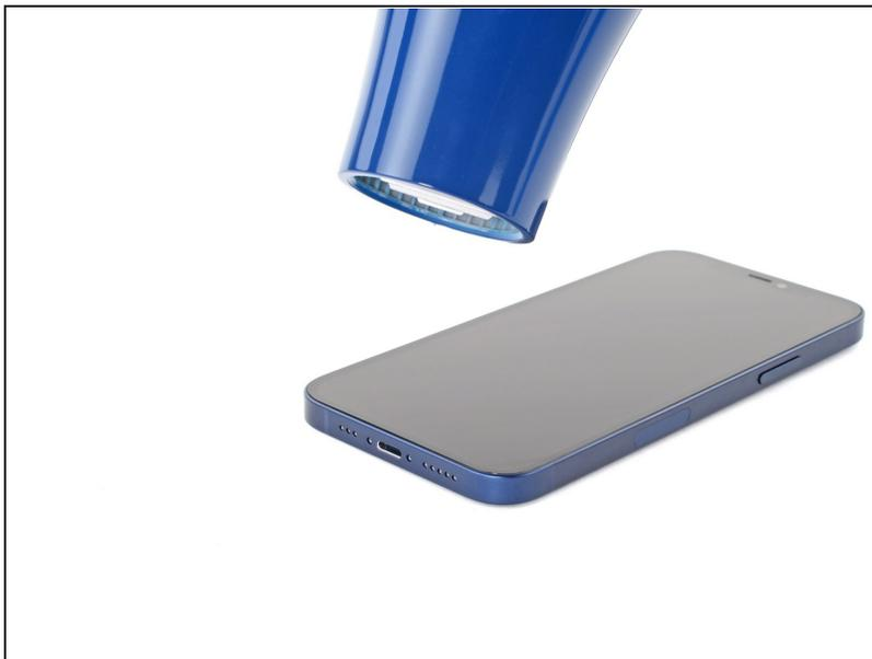
① ヘアドライヤーもしくはヒートガンを、iPhone下側の端に約90秒当てて、触れると熱くて触れない程度までスクリーンを温めます。
