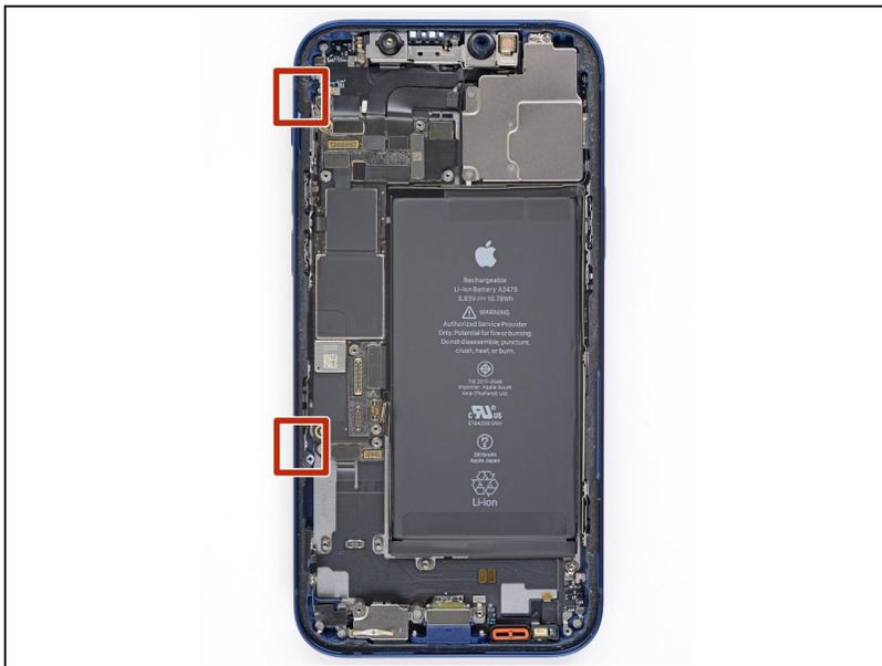
⚠️ iPhoneの左側端に沿って、デリケートなケーブルが装着されています。この部分にピックを差し込まないでください。ケーブルを破損する恐れがあります。
