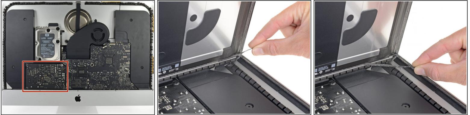
**⚠️** コンデンサのリード線または電源の背面の露出したはんだ接合部に触れないように十分注意してください ( 赤色の枠内 )。
