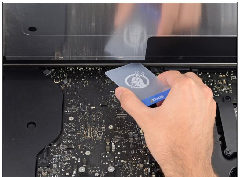
**i** 必要に応じて、プラスチックカードを使って接着ストリップの残りの部分を切断してください。
