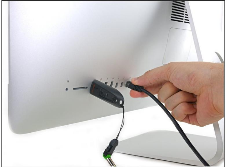
☑️ iMacを再組み立てするときは、外付けI/Oポートの位置が正しく合わさっているか、十分注意してください。ロジックボードは、すべてのネジで固定されていても、曲がった状態のまま取り付けることが可能なためです。
