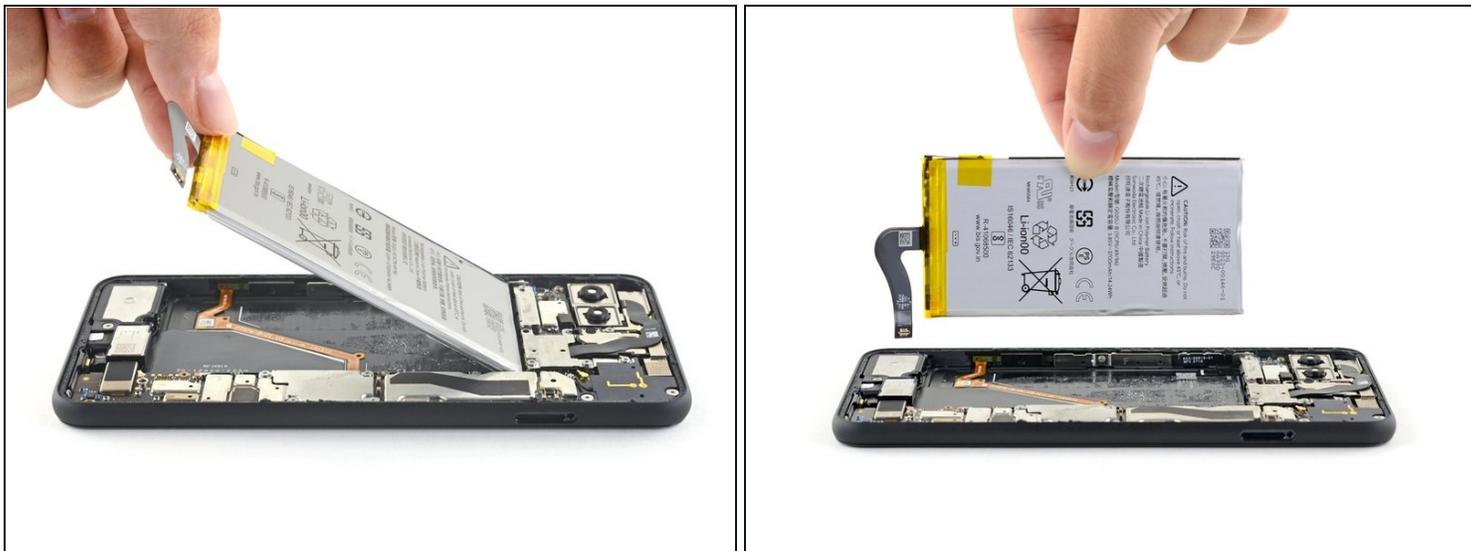
**⚠ 一度取り出したバッテリーの再利用はしないでください。潜在的な危険性が潜んでいます。必ず新しいバッテリーに交換してください。**
