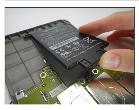
● バッテリーの下側から慎重に持ち上 げて、ミッドフレームからスライド して取り出します。
