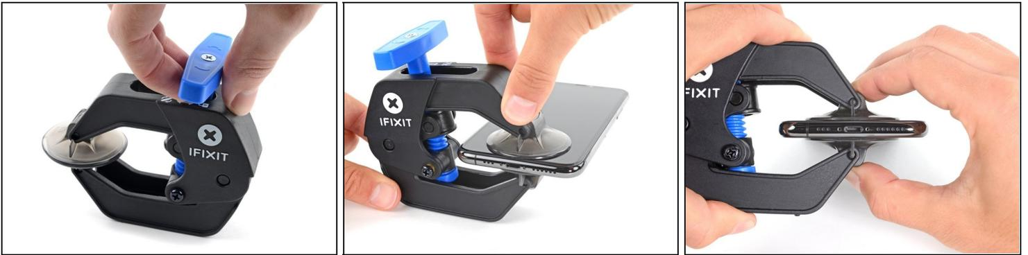
① 次の3つの手順では、デバイスの開講作業を簡単にするために開発されたツール、リバースクランプの使い方を紹介します。リバースクランプを使用しない場合は、この3つの手順をスキップして別の方法をご覧ください。
