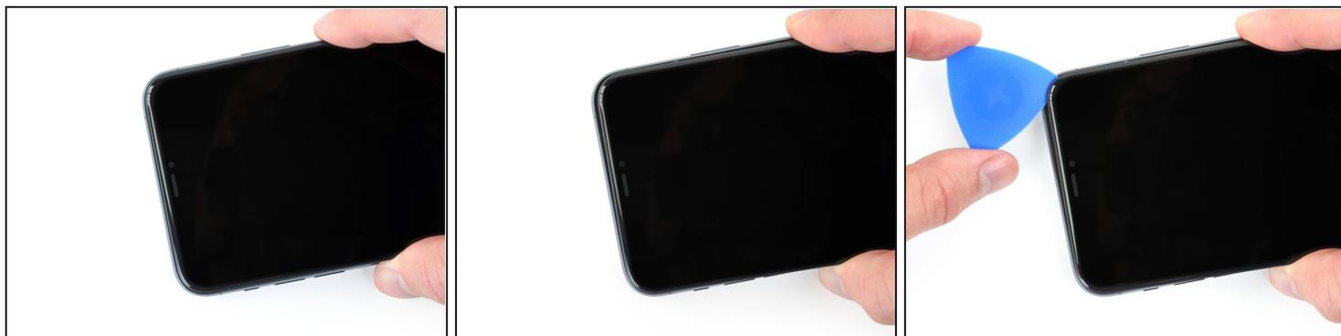
① ディスプレイの上部端は接着剤とクリップ両方によって固定されています。
