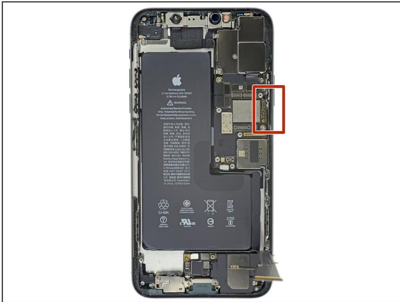
⚠️ iPhoneの右側端に沿って、デリケートなケーブルが装着されています。この部分にピックを差し込まないでください。ケーブルを破損する恐れがあります。
